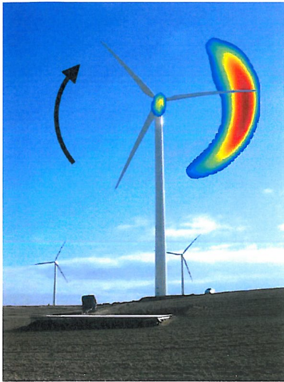
Figur 1. Fotografi och ljudintensitet från en akustisk kamera visas tillsammans. Ljud genereras huvudsakligen på yttre delen av bladet samt till viss del vid rotorn. Figur från Oerleman et al. (2007)
